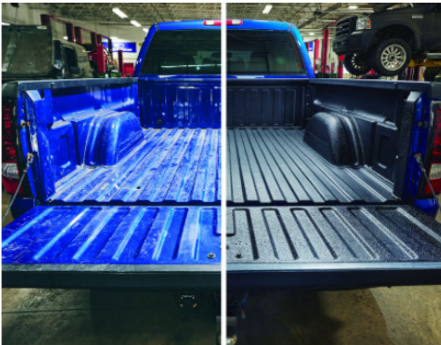
Utilisation de RAPTOR dans l'application traditionnelle de benne de pick-up
