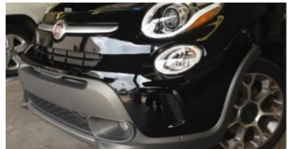
RAPTOR teintable appliqué comme revêtement de protection contre les éclats sur une couche de fond à base d'eau.
