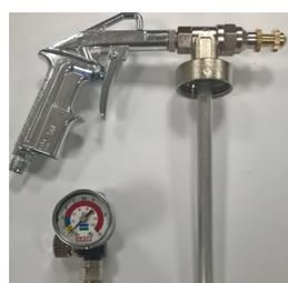
Une fois nettoyé, remplacez la buse extérieure et revissez le récipient de nettoyage puis pulvérisez jusqu'à ce que le tube et le corps du pistolet soient propres. Vous êtes prêt à peindre à nouveau.
