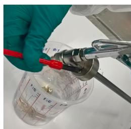
Détachez le pistolet de l'alimentation d'air, dévissez la buse extérieure et immergez-la dans les diluants en nettoyant avec une brosse à poils courts.
