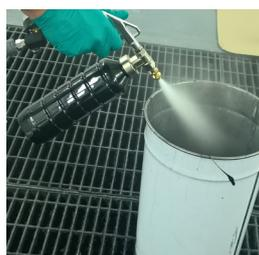
Vissez une bouteille contenant des solvants de nettoyage et pulvérisez pendant 10-15 secondes (ceci nettoiera l'intérieur du tube d'absorption).
